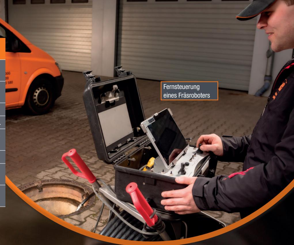
Fernsteuerung eines Fräsroboters
