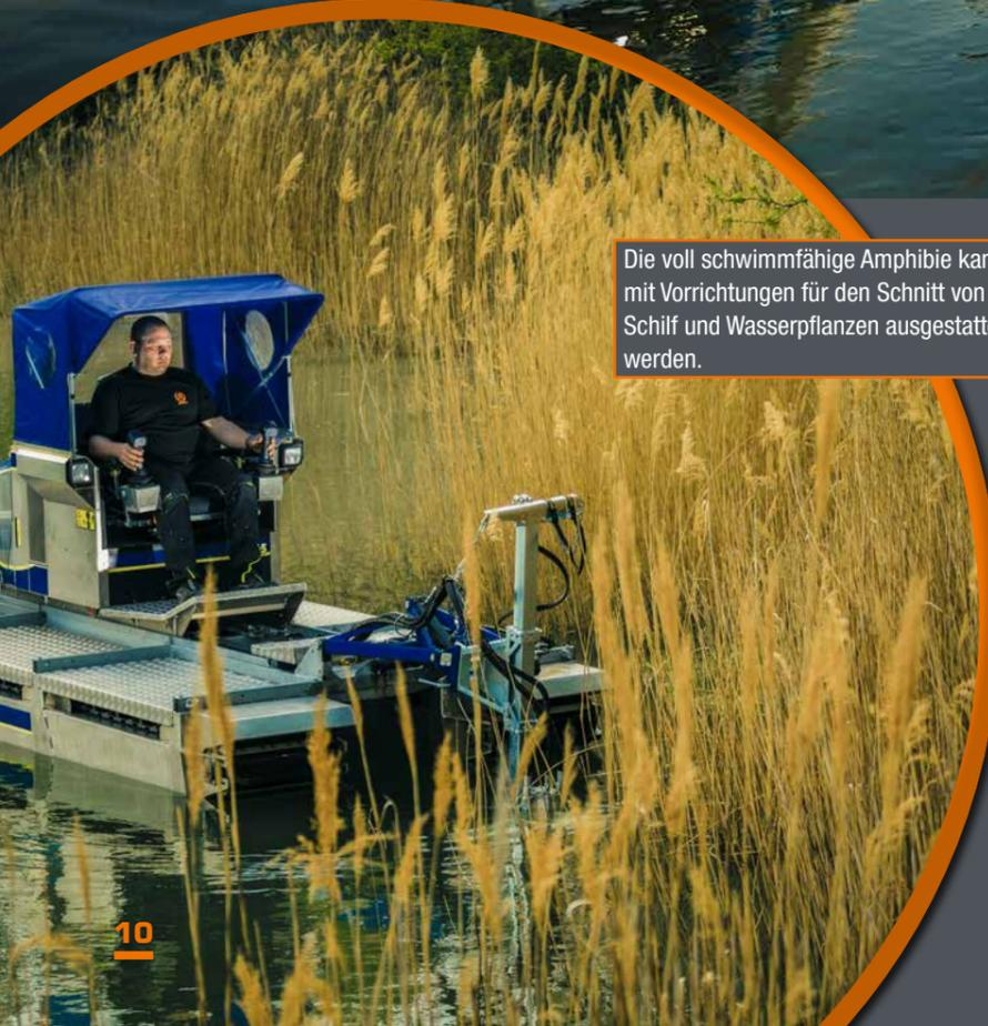
Die voll schwimmfähige Amphibie kann mit Vorrichtungen für den Schnitt von Schilf und Wasserpflanzen ausgestattet werden.
