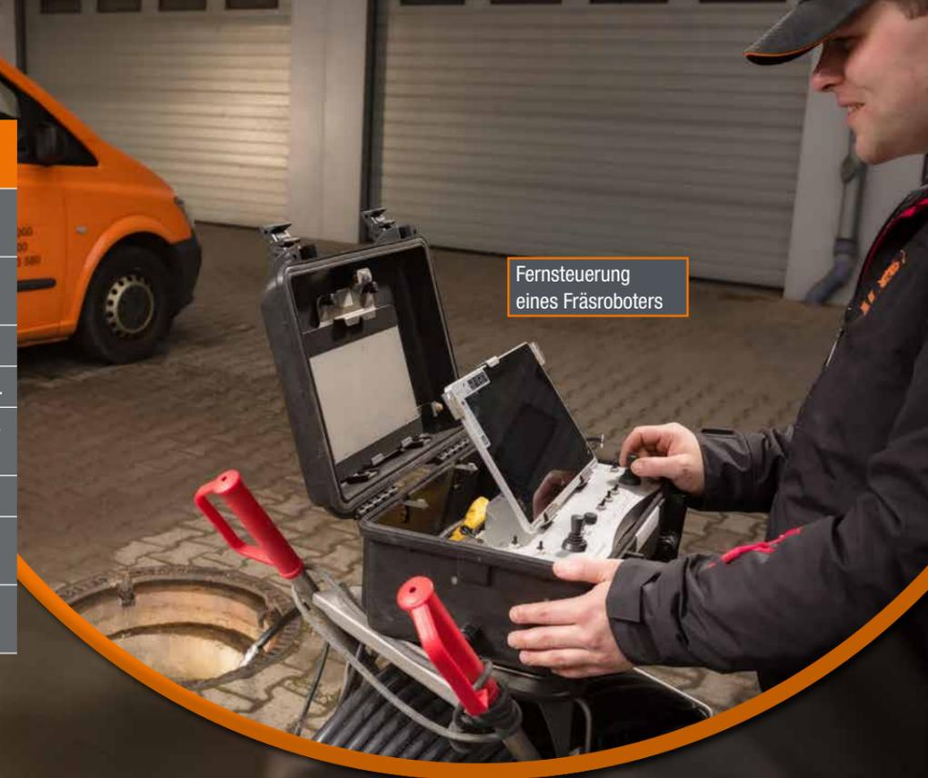
Fernsteuerung eines Fräsroboters
