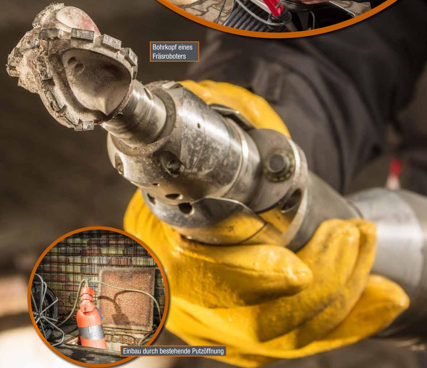
Bohrkopf eines Fräsroboters
