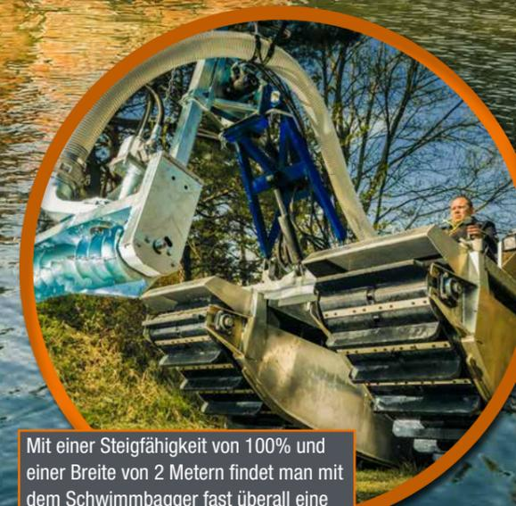
Mit einer Steigfähigkeit von 100% und einer Breite von 2 Metern findet man mit dem Schwimmbagger fast überall eine Zufahrt zur Wasserfläche ohne großen Schaden anzurichten.
