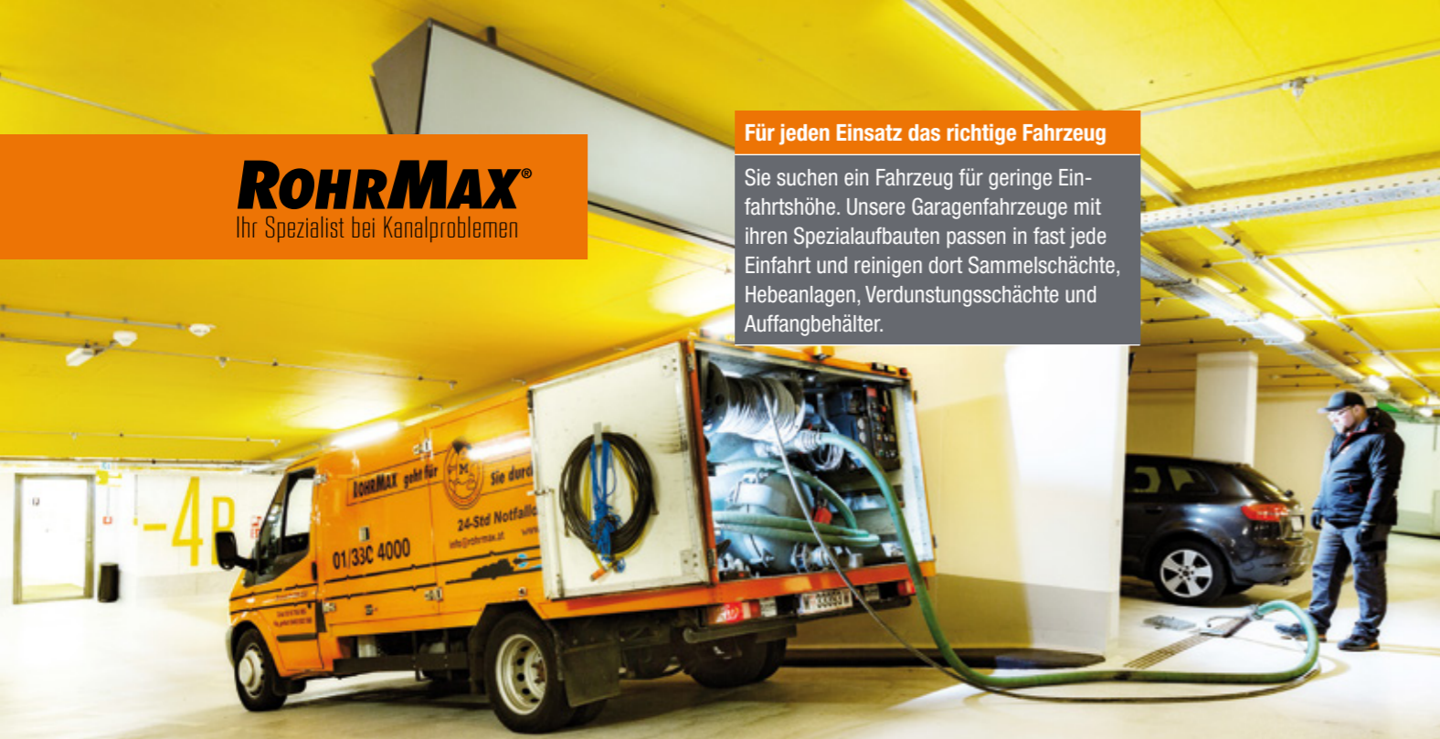
Garagenfahrzeug für Einfahrtshöhen unter zwei Meter
